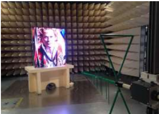
Essai en cage anéchoïque Exemple de mesures d'investigations CEM sur panneau P6
