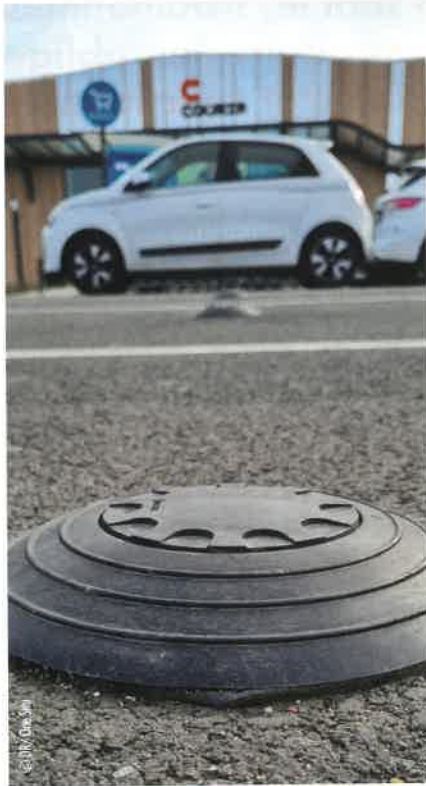
▲ Un capteur détecte la présence ou non d'un véhicule (One Situ).
