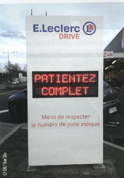
◀ Chez E. Leclerc (Saint-Malo et Strasbourg), les capteurs installés sur les pistes de drive détectent la présence d'un véhicule. L'afficheur indique ensuite la disponibilité ou non des pistes (One Situ).
