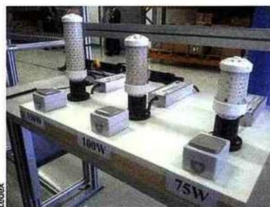
La start-up Ledex, installée à Chambly (Oise), a conçu une ampoule à leds immergées dans une huile de synthèse recyclable, sans entrée d'air. Par effet de loupe, celle-ci permet d'atteindre
