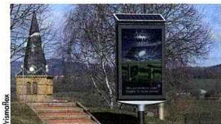
Le fournisseur de panneaux publicitaires Prismaflex a installé ses premiers panneaux autonomes en énergie, à Lyon et en Belgique. Ces derniers produisent leur propre électricité grâce à la technologie photovoltaïque transparente de Wysips. Des démonstrateurs ont permis de la valider sur des surfaces de 2 et 8 m<sup>2</sup>. Durant le premier semestre 2014, des sites pilotes sous différentes latitudes et expositions ont conduit à affiner les conditions d'implantation. La surface photovoltaïque
